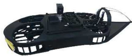
水力発電所鉄管点検ドローン
